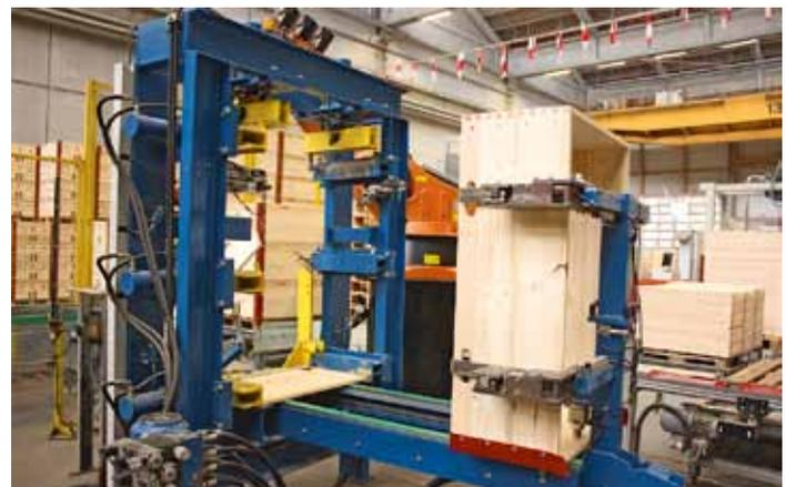
**Wie von Zauberhand:** Zwei Roboter setzen die Einzelteile vollautomatisch zu fertigen Aufsteckrahmen zusammen
